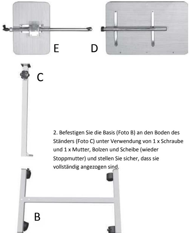
2. Befestigen Sie die Basis (Foto B) an den Boden des Ständers (Foto C) unter Verwendung von 1 x Schraube und 1 x Mutter, Bolzen und Scheibe (wieder Stoppmutter) und stellen Sie sicher, dass sie vollständig angezogen sind.
